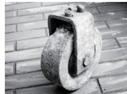
残された滑車。 直径18cm重さ13kg
